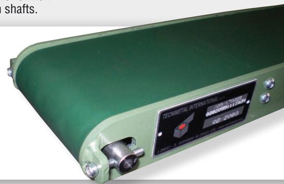
Système universel pour le transport des pièces finies et des rebuts métalliques de découpage et d'estampage. Les pièces sont entraînées par une bande en caoutchouc dont les dimensions dépendent des exigences de nos clients.
