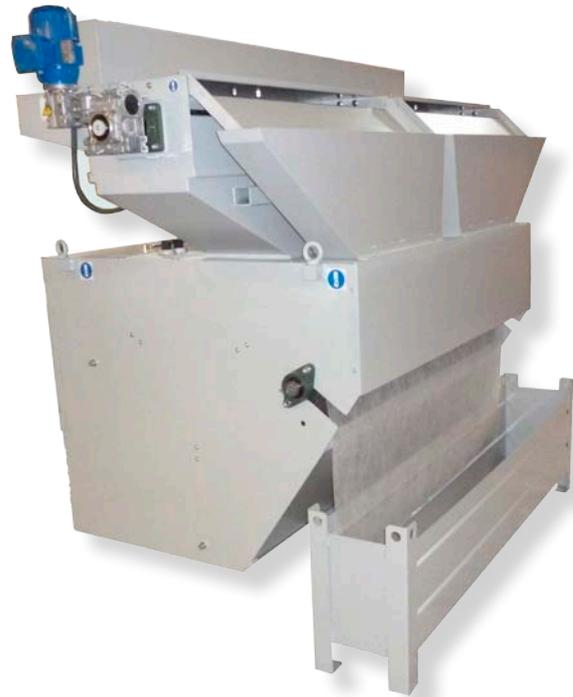
HG ist ein leistungsstarker, schlagfester Hochleistungsfilter, der Vliesstoff als Filtermedium verwendet. Der HG Bereich kann bis zu 600 Litern pro Minute ordentlich Öl zwischen 200 und 1200 Litern pro Minute von Emulsionen auf Wasserbasis, verschmutzte entweder mit metallischen und nichtmetallische Partikel behandeln.
