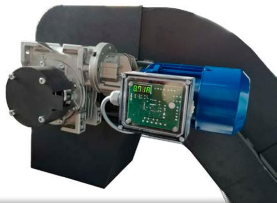
Detto limitatore di corrente prevede di definire un range o intervallo di lavoro compreso tra un valore minimo ed un valore massimo di corrente in funzione della potenza del motore e della tipologia del convogliatore. Se la corrente assorbita dal motore è inferiore al valore minimo o superiore al valore massimo, il limitatore di corrente genera un allarme che trasmette un segnale alla macchina utensile comportando generalmente l'arresto immediato o temporizzato del motore.
